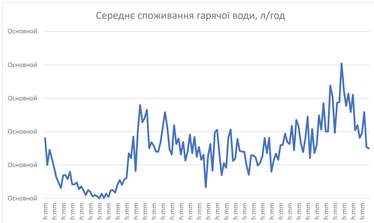
Рис. 2. Усереднені дані споживання гарячої води протягом доби в багатоквартирному житловому будинку
