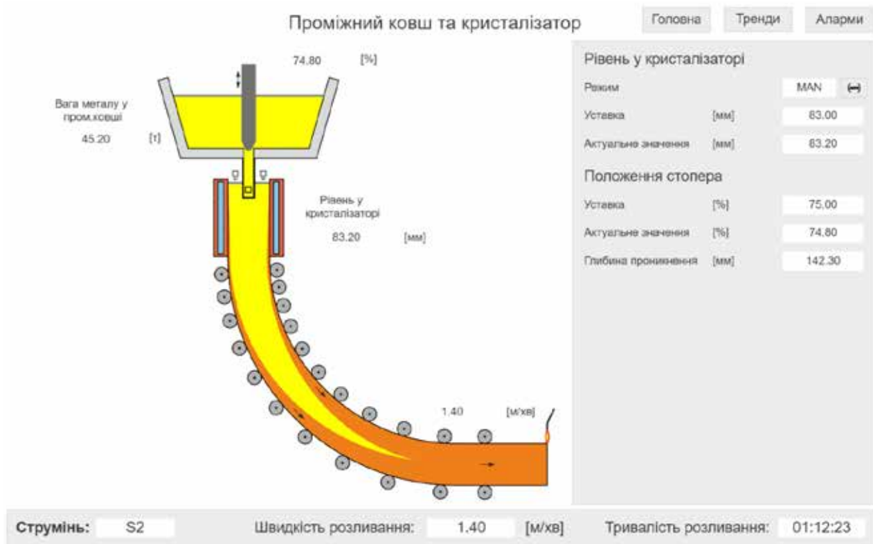
Рис. 13. Головна сторінка розробленої системи візуалізації технологічного процесу керування рівнем у проміжному ковші та кристалізаторі МБЛЗ
